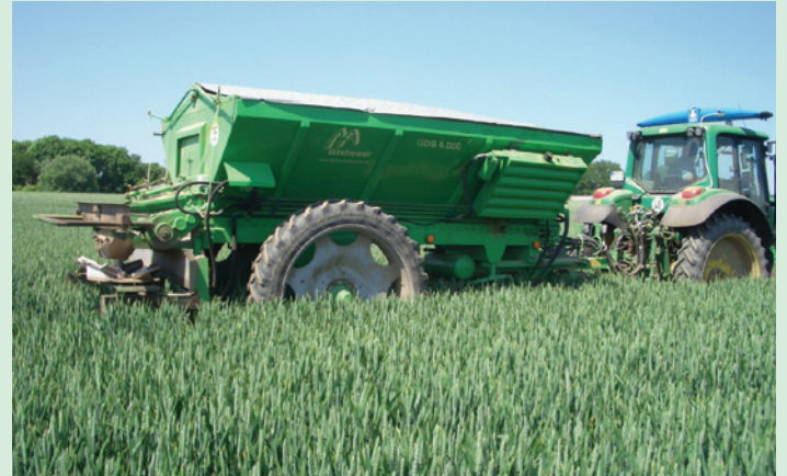
Elektronisch hydraulischer geregelter Großflächenstreuer im Einsatz mit Yara-N-Sensor.
