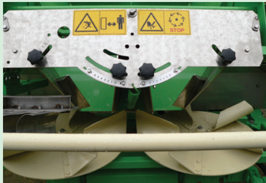
Einstellung des Aufgabepunktes in Querrichtung über Leitbleche.
