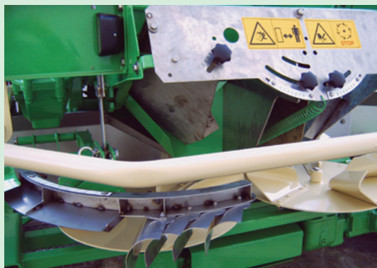
Grenzstreuen incl. Abweiser II eingeschaltet.
