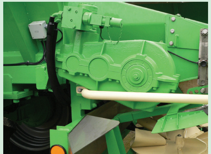
Getriebe für den Antrieb des Kratzbodens. In Kombination mit dem Proportionalventil wird die Kratzbodengeschwindigkeit reguliert.
