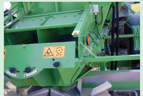
Hydraulisch betätigte Klappe, verhindert Rieselverluste bei Straßenfahrt.
