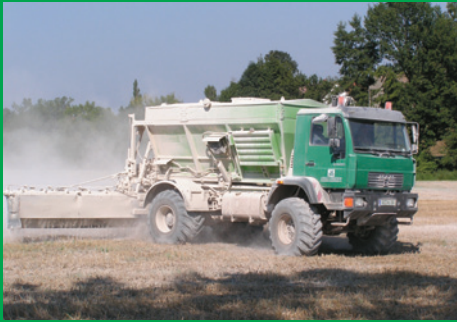
MAN mit Streuaufsatz und 8 m - Streuschnecke.
