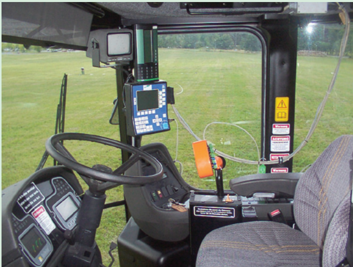
Bordcomputer über serielle Schnittstelle mit Fremdelektronik gekoppelt (teilflächenspezifische Düngung).
