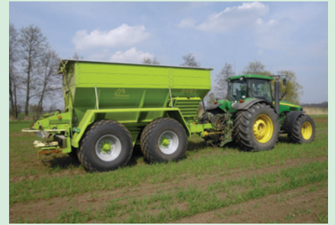
GDK 8.000 T (14m 3 ) mit Bogie-Achse für die Kalkung und Grunddüngung.
