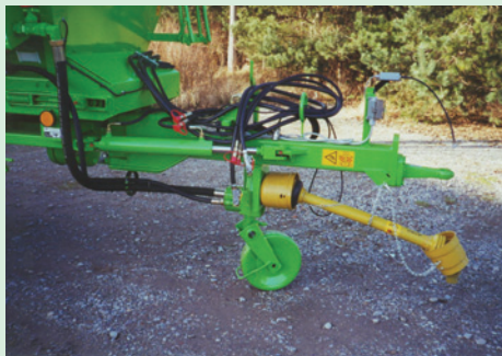
Automatik-Lenkdeichsel, für spurtreues Fahren.
