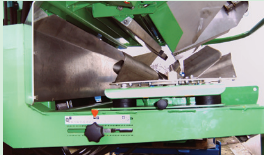
Werkzeuglose Einstellung des Streuwerkes.
